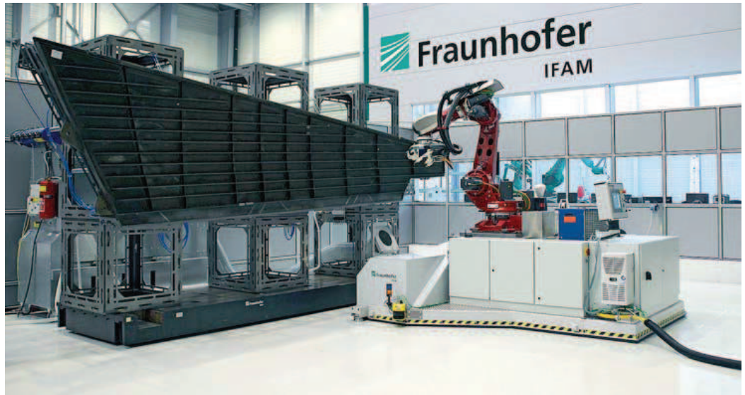
ProsihP II-Gesamtanlage: Nach der Entwicklungsphase wurde die selbsttätige Anpassung mobiler, robotergestützter Fräsprozesse an differierenden Bauteilgeometrien und -positionen bei einer 7x2m großen CfK-Seitenleitwerksschale des Airbus A320 erfolgreich getestet. Das System ist aber auch für deutlich größere Bauteile mit Längen bis 30m ausgelegt. Damit ist es für unterschiedliche Flugzeug-Primärstrukturen wie Flügelschalen oder Rumpfssegmente anwendbar.
